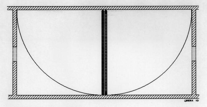
2 Motorgetriebene und gesteuerte Flügeltore In einem rechteckigen Raum in der Mitte der Längsseite montiert. Öffnen und schliessen sich und verweilen in Grundstellung an der Wand.
