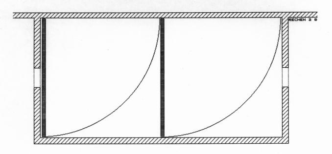
2 motogetriebene Schwenktore bewegen sich in Schrittgeschwindigkeit. In einem rechteckigen Raum mit Je einem Eingang an den Stirnseiten sind die Tore in einer Ecke und in der Mitte der Längseite montiert. Die beiden Eingänge sind durch einen 2. gemeinsamen Raum begehbar.
