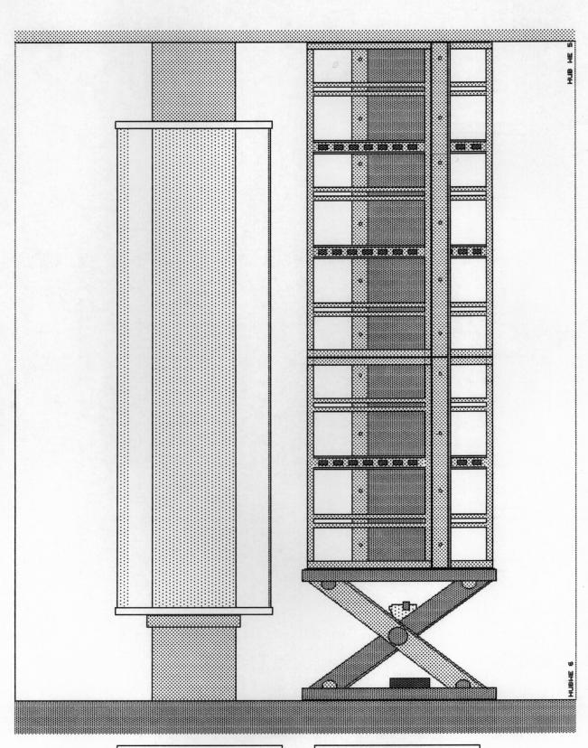
VITRINE OHNE INHALT GLASZYLINDER H= 200, d= 80 CM STAHLKONSTRUKTION OBEN UND UNTEN doka STÜTZENSCHALUNG ALU-FRANAX SI MIT GELBER SCHALTAFEL H= 240, B=120 T=120 SCHERENHUBTISCH H= 75 B= 120 T=100 CM, BLAU,TREPEL EN20/8-1 Title Hubwerk I Year 1996
