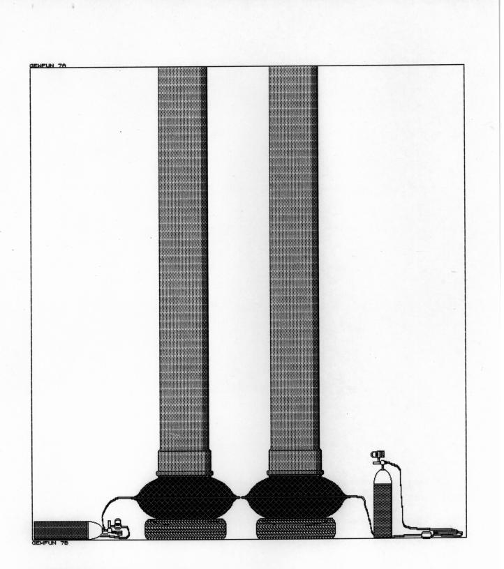
4 HOCHDRUCK-HEBEKISSEN VP 42 MIT STEUEREINHEITEN UND 2/4L DRUCKLUFTFLASCHEN 4 KUNSSTOFF-ABHASSERFOHRE Ø= 31,5 cm 4 ZERSTÖRTE PKW REIFEN MIT FELGEN
